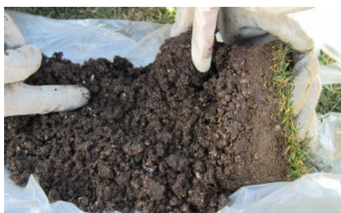
図 3 手触により崩れるグラスミックス
